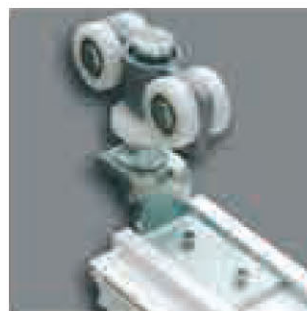
Ouverture et fermeture facilitées : Elles se font sans effort en mode manuel grâce au double guidage. La porte est suspendue dans le rail haut à l'aide de chariots munis de 4 galets montés sur roulements à billes.
