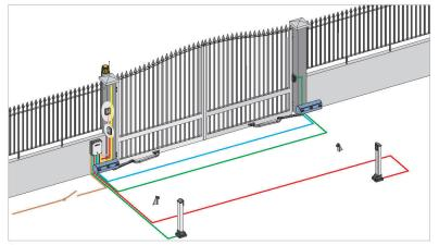
$\label{eq:approx} \mbox{ATTENTION utilisez toujours des câbles souples et protégez bien l'arrivée de ceux-ci au boitier électronique. \\ ^{\mbox{Pour les moteurs 24V, utiliser un fil de } 2x2.5 \mbox{ mm}^2 \ .}$ Distance maximale entre moteur et centrale: 10m.
